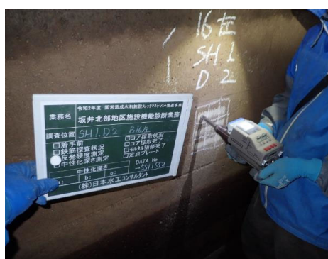
コンクリート強度推定試験状況
