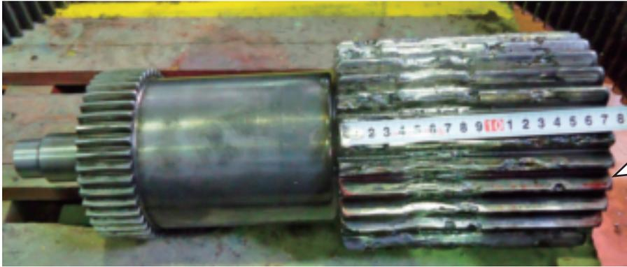
平成25年度に七穂排水機場の1号ポンプが故障したため、応急対策を実施しました。減速機内部を確認したところ、太陽歯車等が損傷していました。
