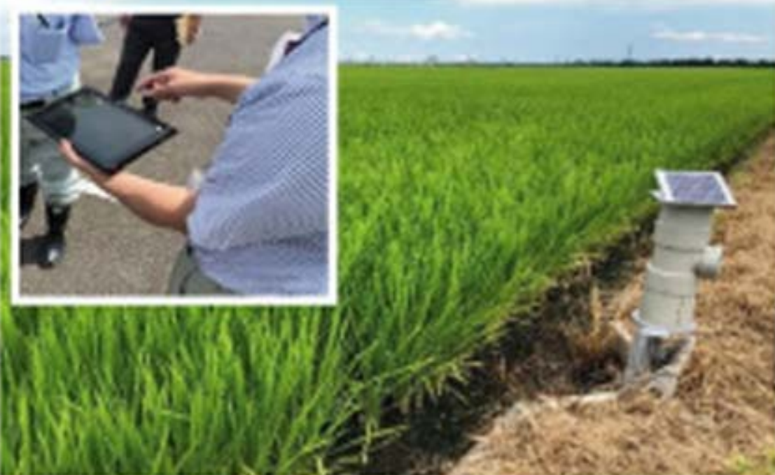
遠隔操作可能な自動給排水栓が設置されたスマート田んぼダム (新潟市江南区)
