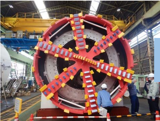
図2 シールド機(掘進前)
