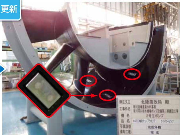
▲ケーシングに設置した犠牲陽極
