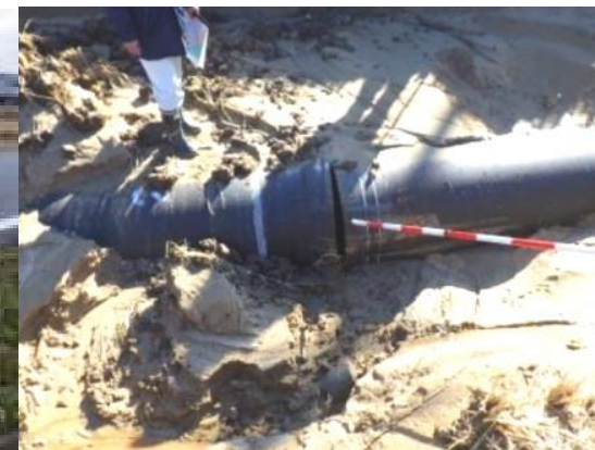
パイプライン埋設道路の被災状況調査及び埋設管破損状況
