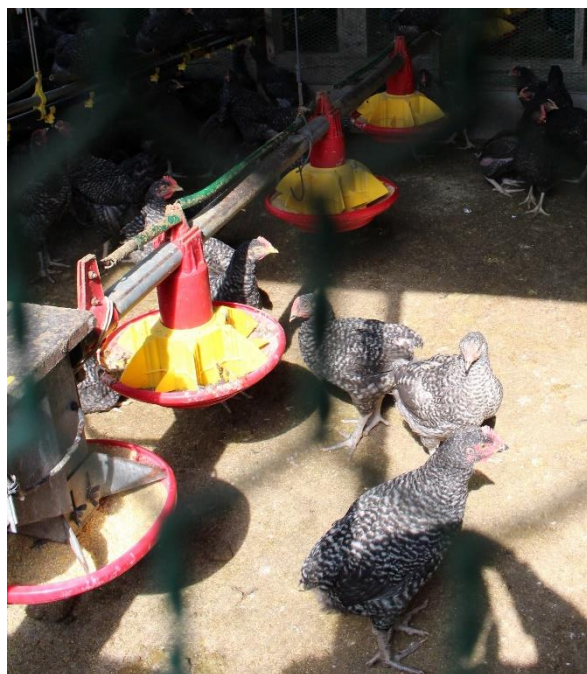
自動給餌機で給餌（赤・黄色の器材が自動給餌機）
