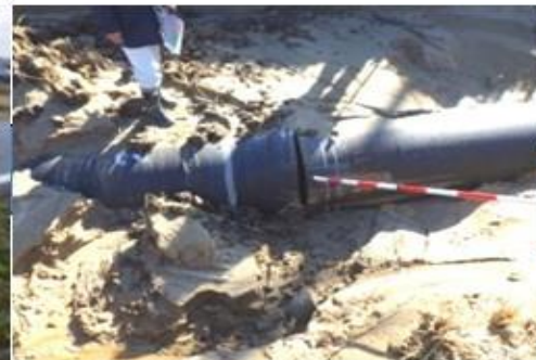
パイプライン埋設道路の被災状況調査及び埋設管破損状況
