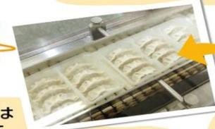
でき上がったギョーザはすぐにトレーに載せられて、蒸し器で蒸してから急速凍結させるんだよ。
