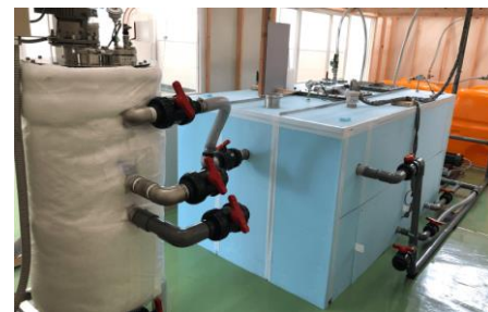
ルーメン微生物を利用 したメタン発酵装置 （石川県立大学）
