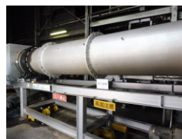
○施設内のもみ殻炭化炉 （内燃式ロータリーキルン炉）
