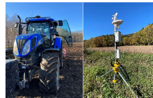
位置補正情報を利用した自動操舵農機
