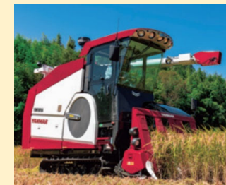
収量センサ付きコンバイン
