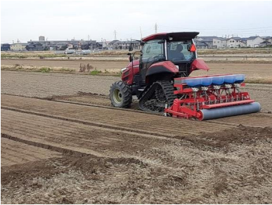
↑ スリップローダーシーダーによる狭畦密植栽培の作業風景
