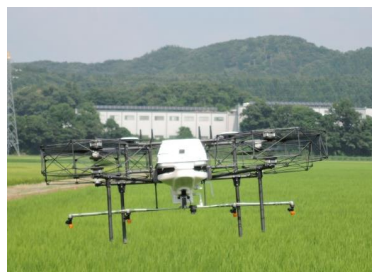
↑完全自動飛行ドローンによる 水稻病害虫防除の様子
