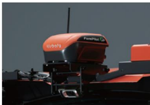
▲補正情報を受信するRTK-GPSアンテナユニット (アグリロボトラクタ)
