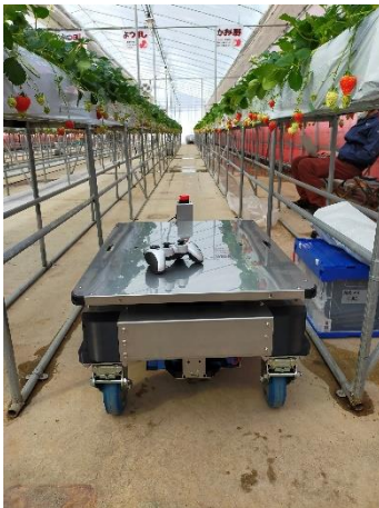
移動ロボット(Type M) (収穫したイチゴの搬送の役割)
