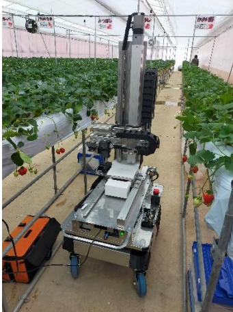
収穫ロボット (移動ロボットの上に設置)
