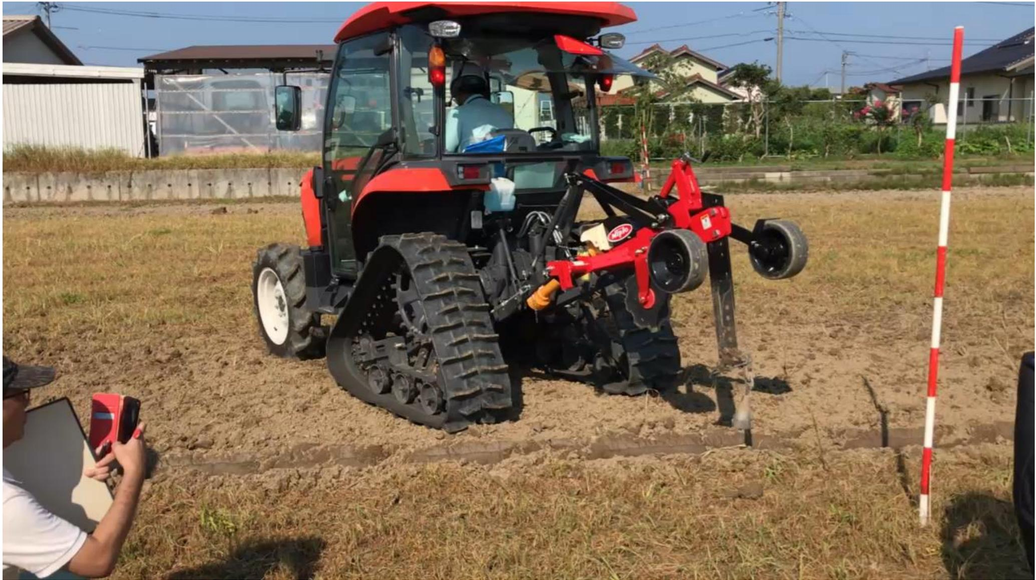
サブソイラ（弾丸暗きよ・耕盤部分破碎）
