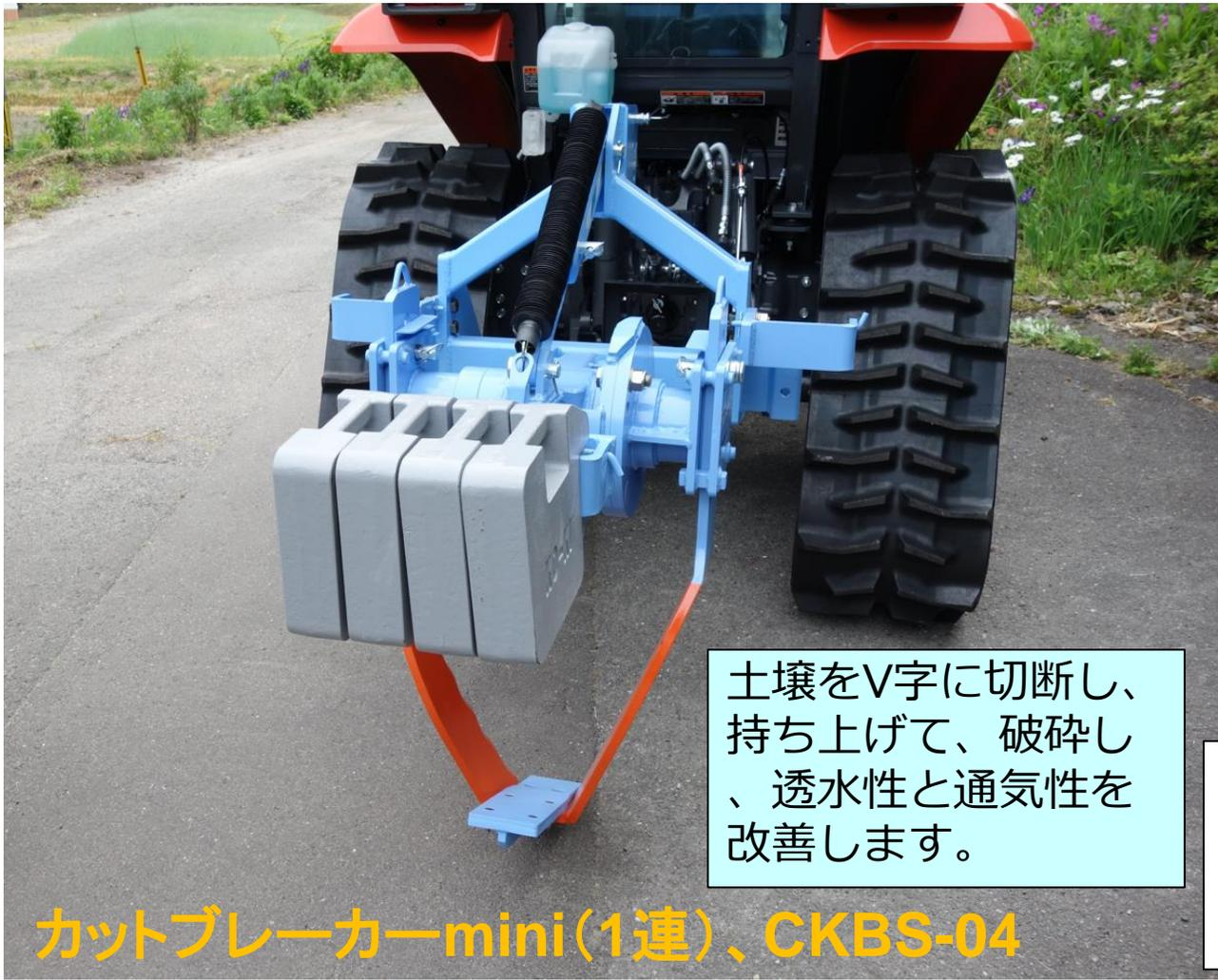
土壌をV字に切断し、持ち上げて、破碎し、透水性と通気性を改善します。
