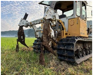
【サブソイラーの弾丸は通常より大きいものを使用】
