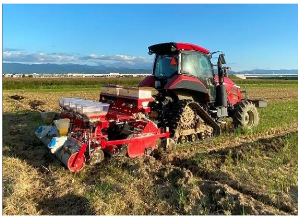
耕起から除草剤散布までの工程を一度に行うための「搭載型シーダ」
