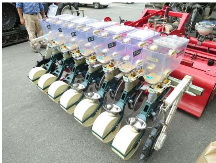
播種機は土のコンディションと種子の大きさによって繰り出し量を調節する
