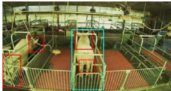
②発情監視システム及び③分娩検知システム
