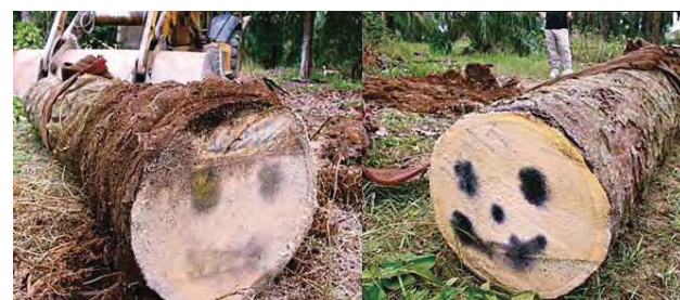
図6 オイルパーム伐採木断面へのヨウ素溶液の噴霧による糖蓄積の可能性判別（左：糖蓄積しないパーム幹、右：糖蓄積するパーム幹）
