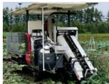
開発中のキャベツの自動収穫機
