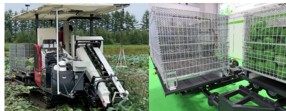
鉄コンテナを搭載した自動収穫機と自動運搬台車
