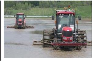
衛星測位データを基地局で補正することにより、高精度の自動走行を実現。
