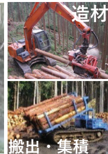
間伐 樹木の混み具合に応じて一部の樹木を伐採（間引き）、搬出・集積する作業。通常、植付後20年目頃から数回実施。
