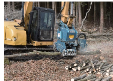
重機によるきのこ原木生産
