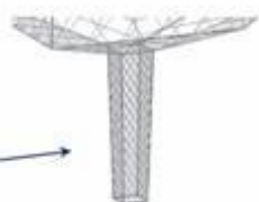
図4 切れたクラゲ排出用筒網図
