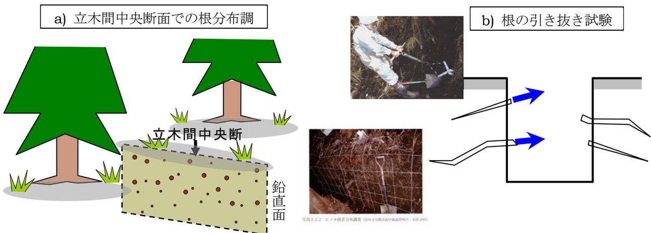
図 2.16 立木間中央断面での根の分布調査と引き抜き抵抗力試験
