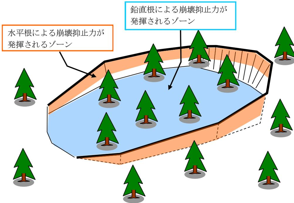
図 2.15 水平根・鉛直根の崩壊防止機能
