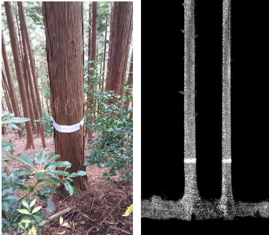
図 2-48 反射テープ（左図：現地写真、右図：点群状況）
