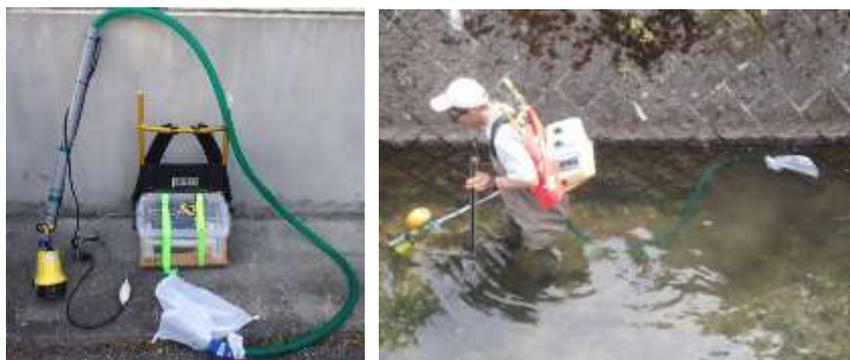
図5 水中ポンプを使用した捕獲装置（左：全体、右：使用状況）
