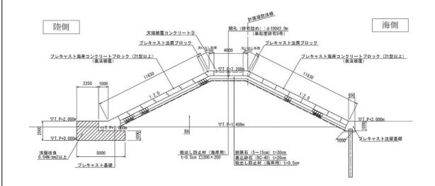
図 3.2.6.14 粘り強い海岸堤防の例(単位:mm)
