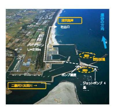
図 3-9-7-1 福田漁港・浅羽海岸サンドバイパス工法 (伊藤ら (2016) <sup>1)</sup> より引用)
