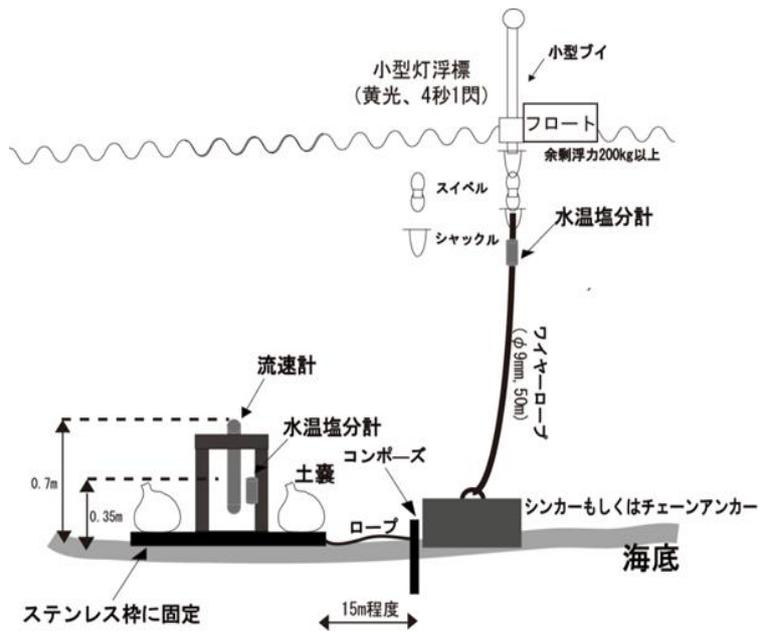
図 42-4 五島列島における係留連続観測の概要図
