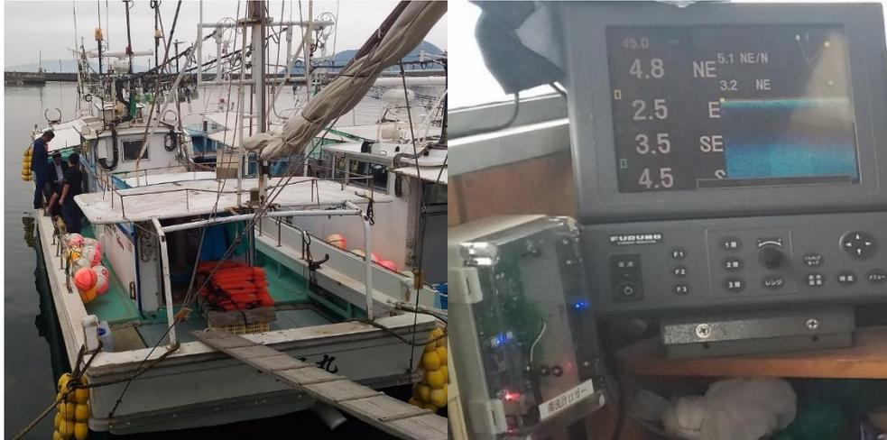
図 11-3 2017 年 5 月、福岡県宗像市（鐘崎漁港）の小型漁船に NMEA（漁船電子信号）データロガーを取り付けた。
