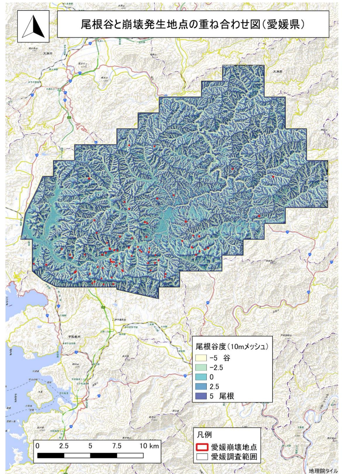
図 3.12 尾根谷度と崩壊発生地点の重ね合わせ図
