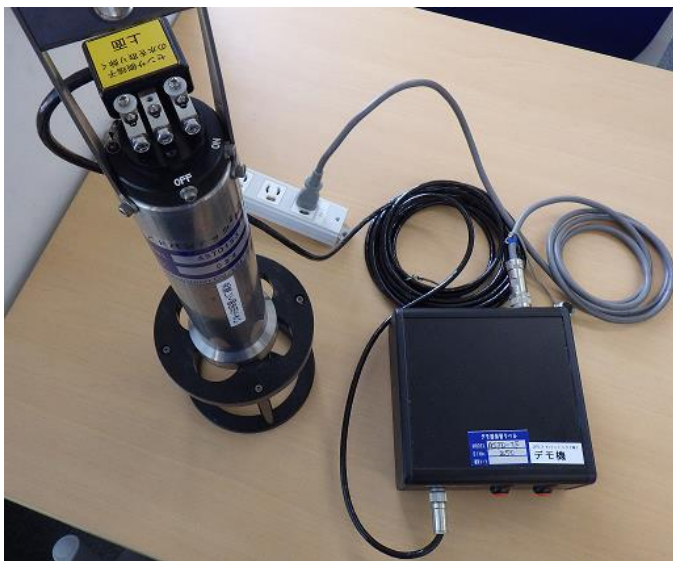
図 12-1 JFE アドバンテック（株）にて Bluetooth 通信機能を追加した高精度 CTD。多数の小型漁船で実証実験した。普段の操業を阻害しないよう、より簡単な操作性が求められる。
