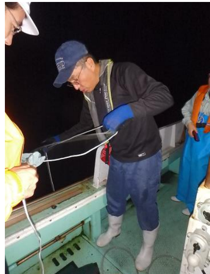
図 12-1 JFE アドバンテック（株）にて Bluetooth 通信機能を追加した高精度 CTD。多数の小型漁船で実証実験した。普段の操業を阻害しないよう、より簡単な操作性が求められる。
