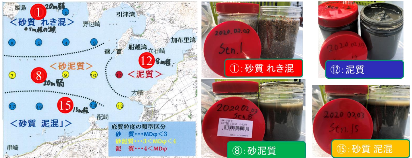
図 34-2 底質マップの評価実験海域と採泥結果。この度の評価は唐津湾において実施した。調査対象箇所は、左図上の赤丸①、⑧、⑫、⑮である。各点の採泥結果が右図である。
