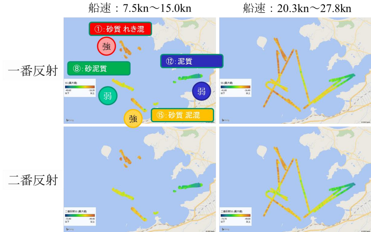
図 34-4 200kHz における一番反射と二番反射の結果。
