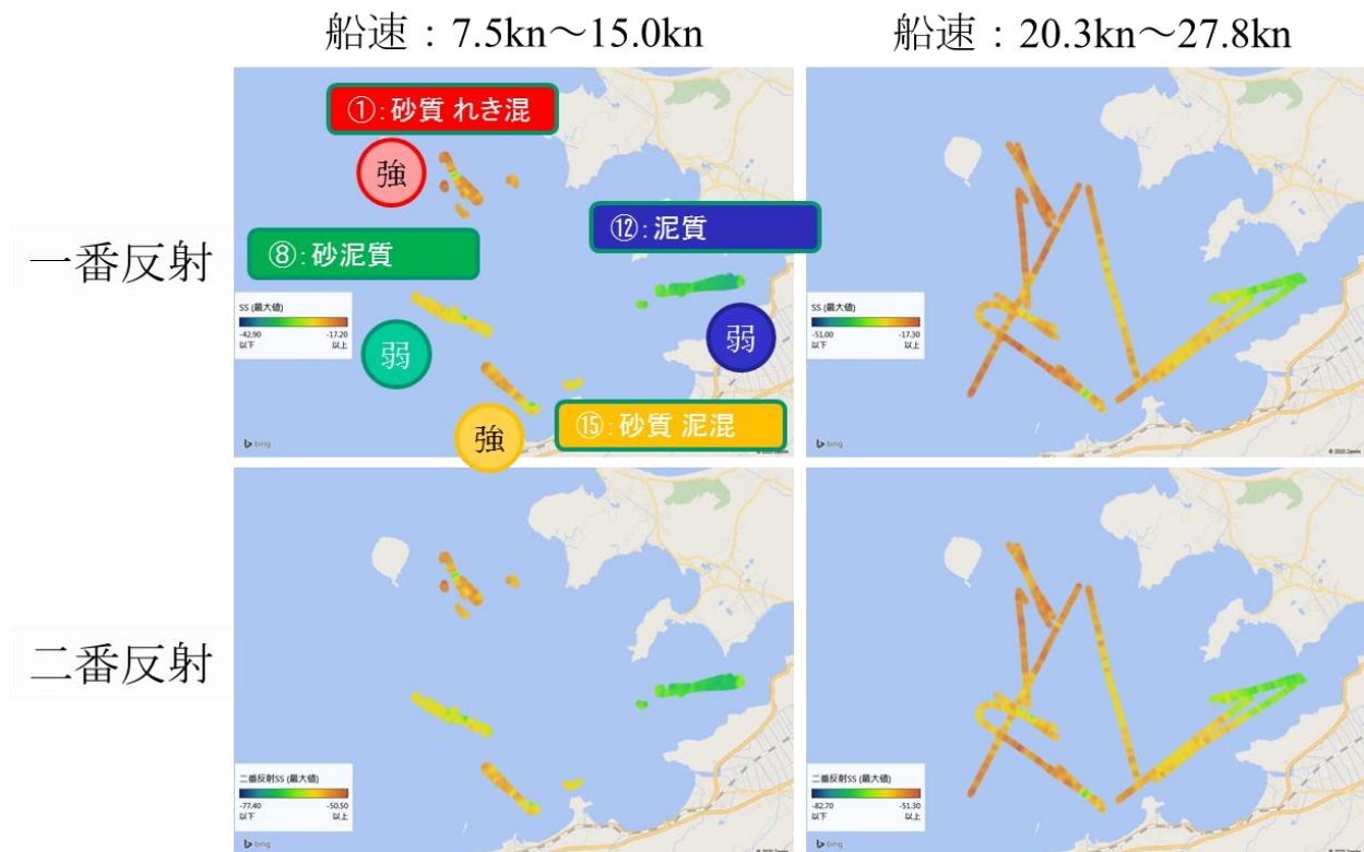
図 34-5 88kHz における一番反射と二番反射の結果。
