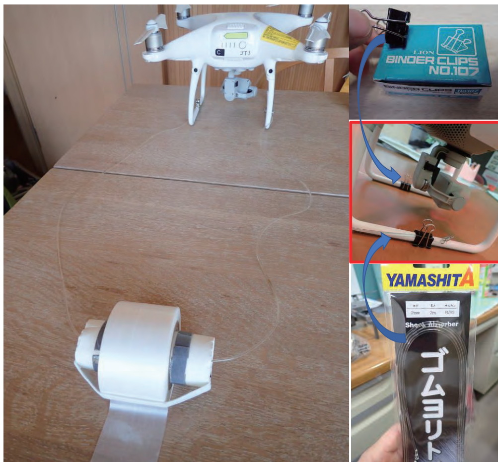
図 2. ビニルテープを吊るす装置（左：全体，右：ドローンとの接続部分）
