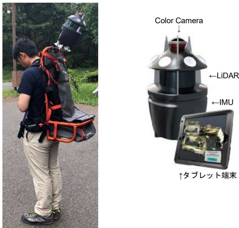
図 5.19 バックパック型レーザスキャナ・3D-Walker
