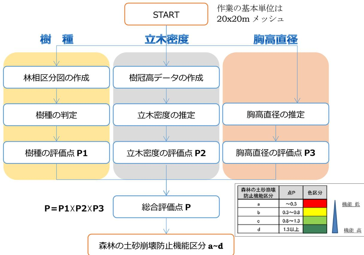
図 3.6 森林の土砂崩壊防止機能区分の判定フロー（林野庁の手引 2016 に基づく）
