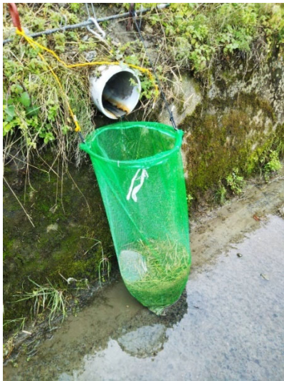
写真1 排水口への網の設置状況（左）と回収した試料の例（右）
