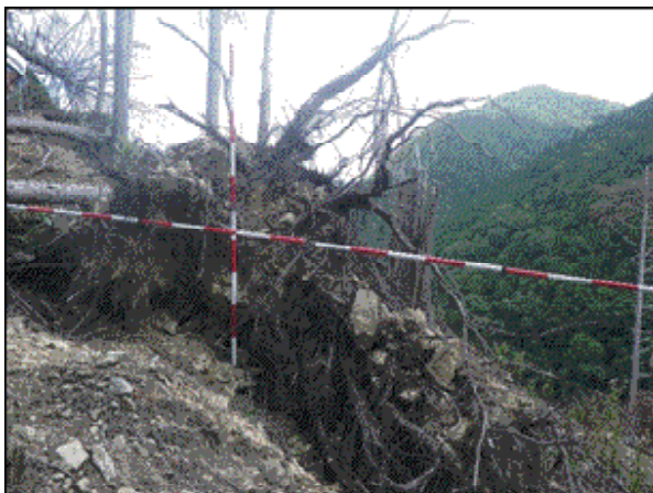
崩壊地上部残存斜面に見られる根返り木の根鉢
