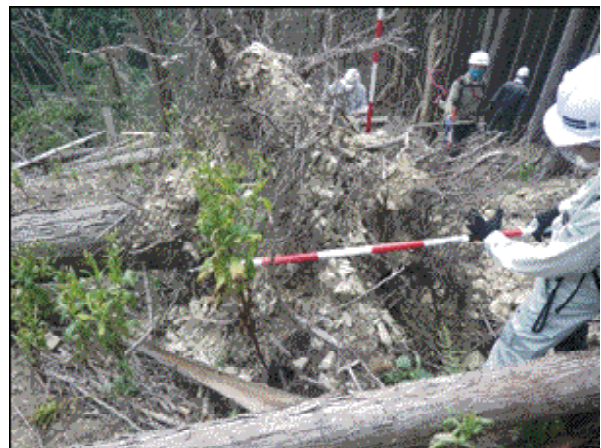
崩壊地上部残存斜面に見られる根返り木の根鉢
