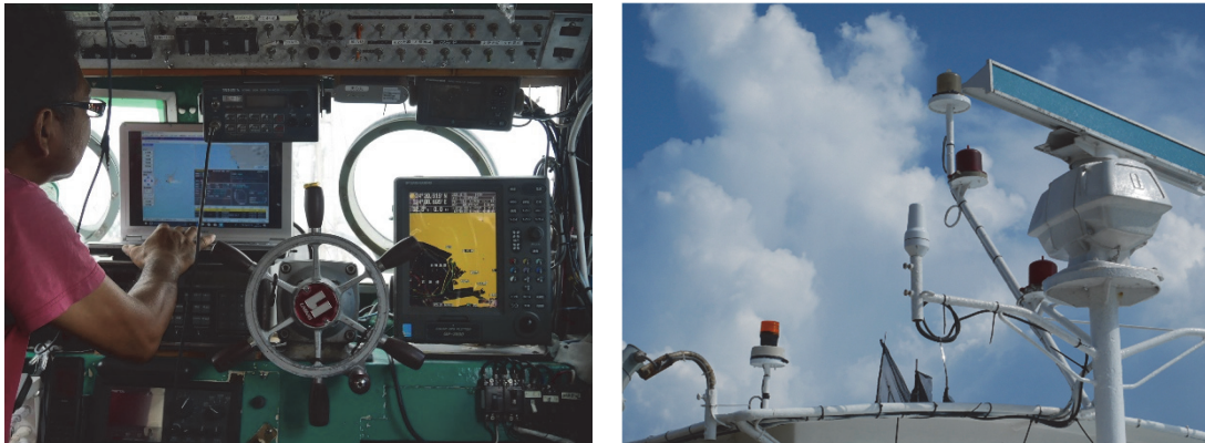
図2-3 マイクロキューブ(左)とカプセルアンテナ(右)の設置状況
