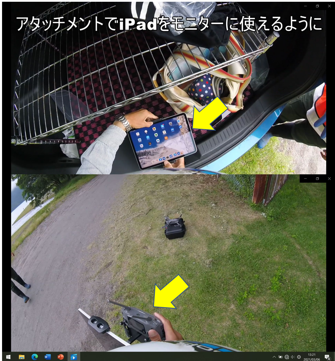
図 1. 操縦用のモニターとして、11 インチのタブレット PC を用い、操作性、安全性を向上させた
