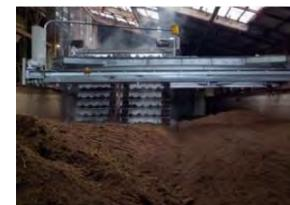
スクープ式攪拌発酵機
