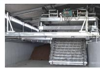
スクープ式攪拌発酵機
