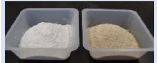
資材（非晶質珪酸カルシウム）と回収品（リン酸肥料として活用）
