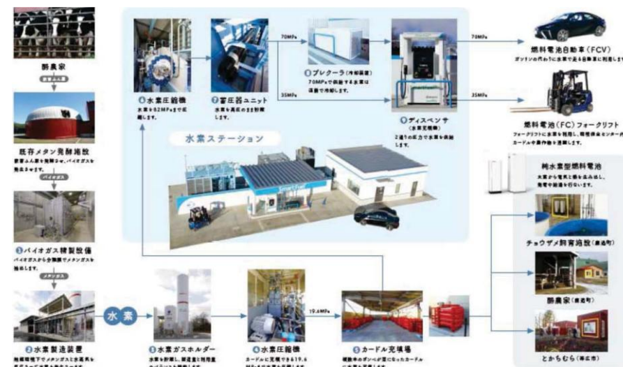
図. しかおい水素ステーション（プラント各設備）
