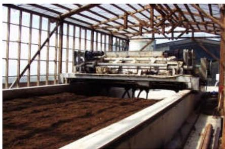
自動攪拌装置等で家畜排せつ物内部の好気発酵を促す(強制発酵すること)で温室効果ガスの発生を削減。
