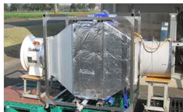
熱風発生器 熱風温度70°C、120kW以上
