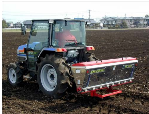
石灰散布機による施用作業
