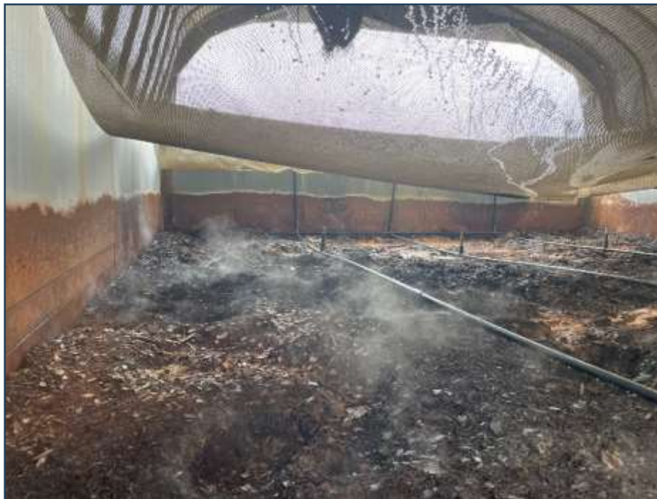
散水を付加したウッドチップ脱臭装置の様子
