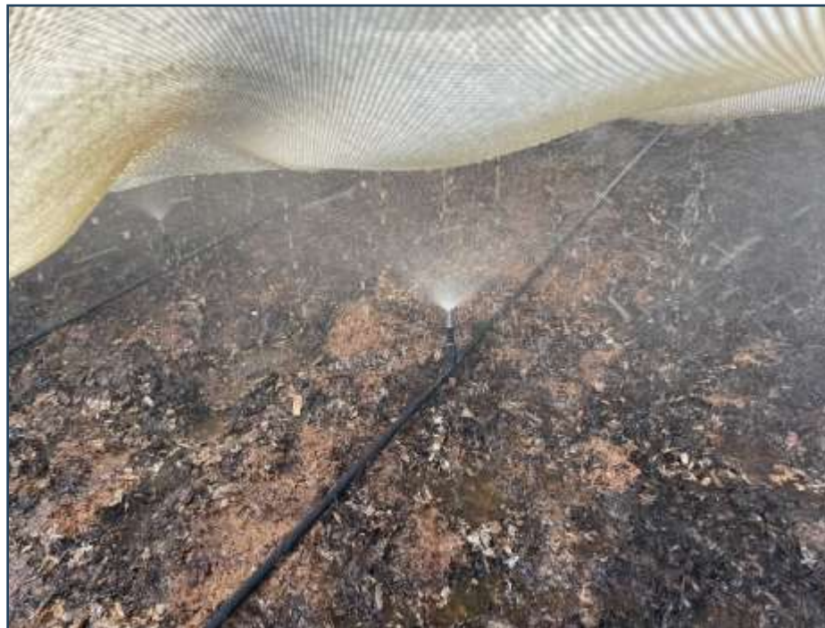
散水を付加したウッドチップ脱臭装置の様子
