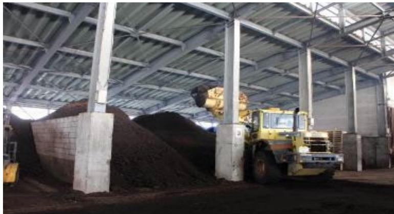
堆肥製造棟での通気堆積と腐熟化
