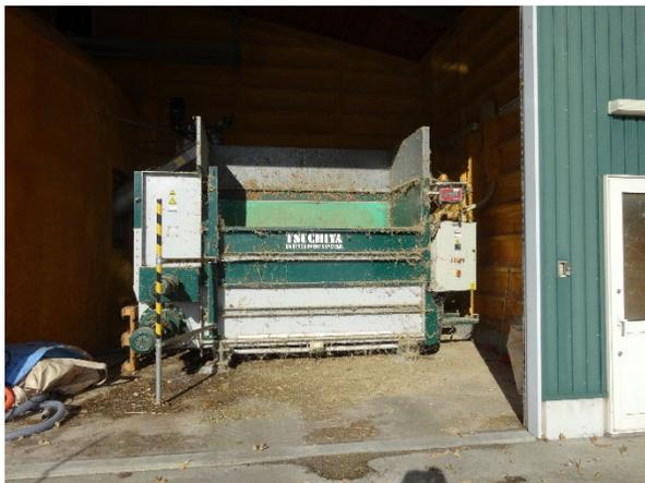
残餌投入装置。発酵槽内液面最上部に投入し、スカム層を作り、硫黄細菌を繁殖させる。
